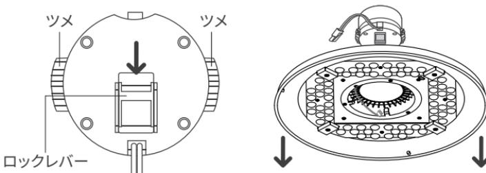
4.固定用プレートの穴を接続コードに合わせます。
