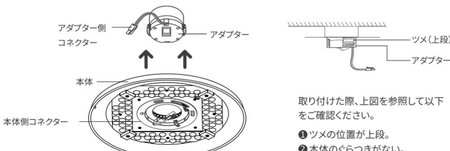
8.本体を取り付けたあと、アダプターのロックレバーを、ロック表記の方向にカチッと音がするまでスライドさせて、ツメをロックしてください。
